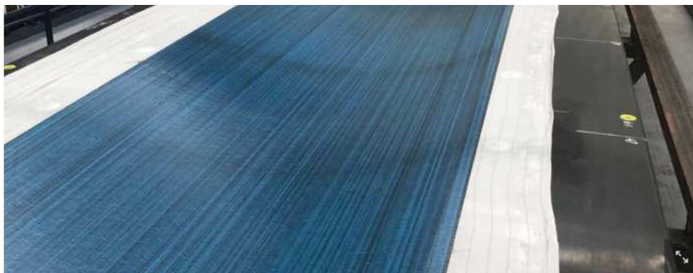
上緯的碳纖複合材料應用於海上風電90米葉型6.45MW施作現場
